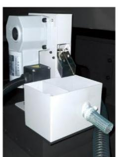
使用水溶性冷却液时，备有油水分离器。
