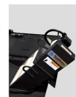
备有冷却液装置B型用磁辊型切屑清理装置。
