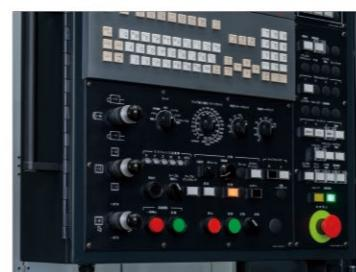
注重手动的可操作性,配备单手柄、工作台90度分度开关、主轴速度旋钮开关等。
