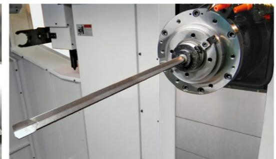
φ 29MC枪钻加工 钻头长度620mm
