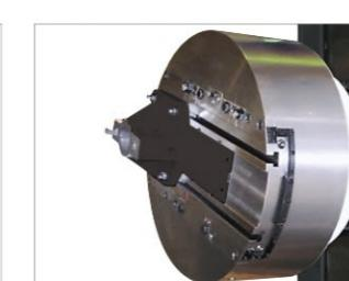
通用平旋盘(平旋盘直径:φ 600mm
