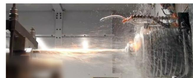
枪钻加工(冷却液压力3MPa)
